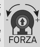
Sur chaque mouvement de démarrage, la centrale applique la puissance maximum pendant 2 secondes, même quand le réglage de la force n'a pas été fait pour le maximum.
